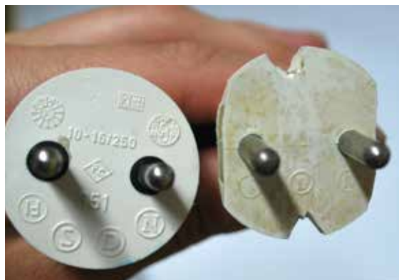
Kuvassa vasemmalla usein vanhoista sähkölaitteista löytyvä pistotulppa, joka ei mahdu nykyisiin pistorasioihin. Itse pistorasiaan sopivaksi tuunnattu pistotulppa (oikealla) on erittäin vaarallinen.
