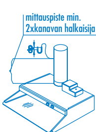
Tehostusilmavirran mittaus
